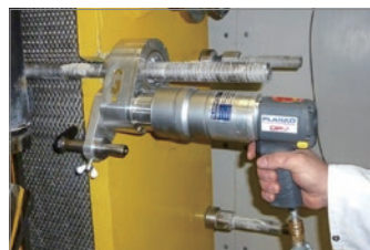
オフセットギアボックス STX：熱交換器のボルト締め ～6,000Nm
