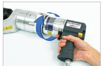
フリージョイント構造で反力で手元が、ねじれずハンドル位置を安全に確保。
