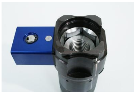
スナップダウン構造はスプリング内蔵でナットへの位置合わせが不要。
