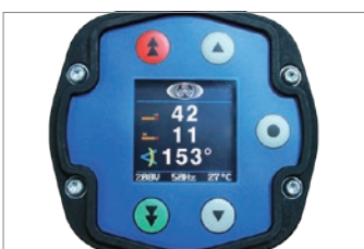
STDプラス：角度締め電動トルクレンチ トルク99段階+角度設定 0~999° トルク管理+角度管理を自動締付け。
