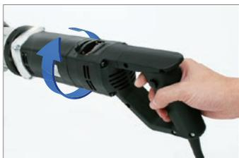
フリージョイント構造で反力で手元が、ねじれずハンドル位置を安全に確保。
