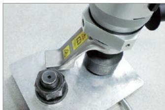
隣のボルトで反力を受け。締め完了後は反力受が自動的に離れ噛み付きません。
