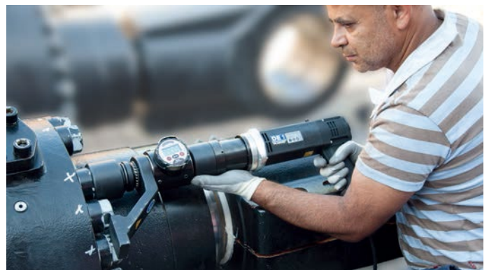
オプション：STトルクメーター デジタル表示。1Nm単位でトルク測定。
