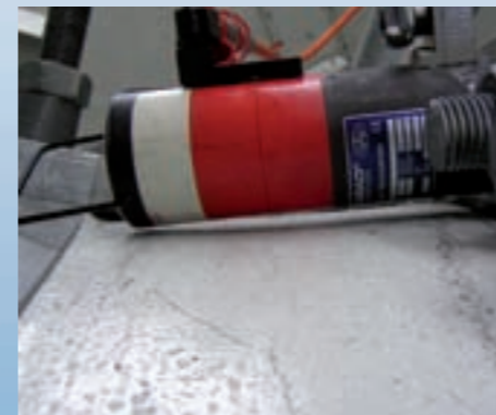
Der Plarad-Spannzylinder beim Ziehen der Blattbolzen.
