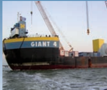
Die „Giant 4“ mit Mannschafts- und Werkzeugcontainern dient als Montageplattform und liegt vor Anker.
