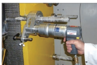
オプション：オフセットギア STX プレート熱交換器のボルト締め用： 最大トルク ~ 6500Nm
