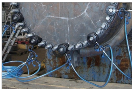
熱交換器のボルトを複数台で同時に並行締め
