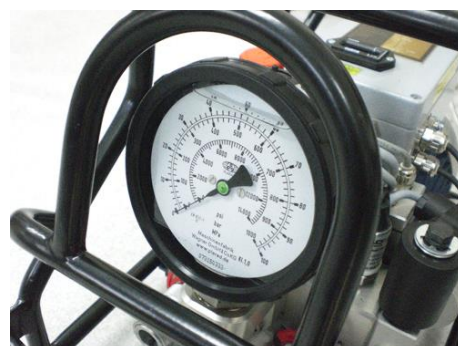
高精度油圧計：MPa、bar、psi 表示
